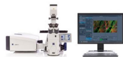
CarlZeiss LSM710 激光扫描共聚焦显微镜
